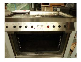
PULL THE FACIA PANEL AWAY FROM THE BOTTOM AND SLIDE TO THE RIGHT TO DISENGAGE THE UPPER BRACKETS THAT LO-CATE IN SLOTS ON THE UNDER-SIDE OF THE HOTPLATE
