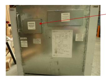
REMOVE THE IGNITION / TERMINAL BOX COVER
