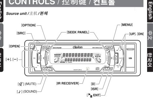
With the FLIP DOWN PANEL opened / 下翻式面板打开的情况下 / 전동 프런트가 열린 상태
