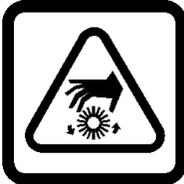
**MOVING PARTS LABEL – LOCATED ON THE SCRUB HEAD ACCESS DOOR.**
