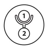
Pin 1 - +12v Pin 2 - GND
