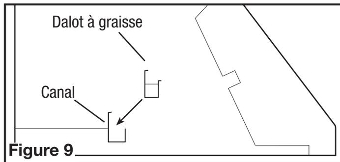
3. Installez les filtres déflecteurs en insérant le haut du filtre dans le canal du haut de la hotte, puis glissez le bas du filtre dans le canal du bas. Les filtres ont un sens pour le haut et le bas. Le bas sur le filtre aura des petits trous pour le drainage. Ces trous doivent faire face vers le bas en direction du dalot à graisse pour être efficaces (Figure 10).
