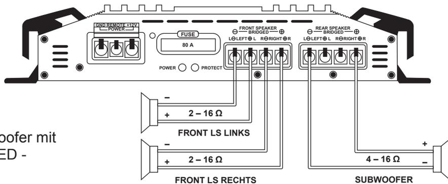
**ACHTUNG:** Bitte vergewissern Sie sich, dass die Polarität der Anschlüsse laut den Beschriftungen übereinstimmt. Fehlerhafter Anschluss verursacht den Verlust des Bass-Signals.
