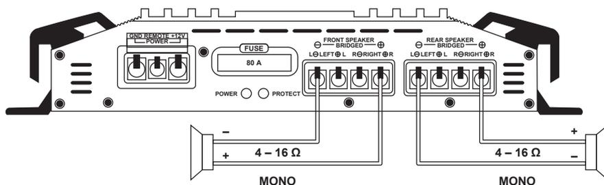
**ACHTUNG:** Bitte vergewissern Sie sich, dass die Polarität der Anschlüsse laut den Beschriftungen übereinstimmt. Fehlerhafter Anschluss verursacht den Verlust des Bass-Signals.
