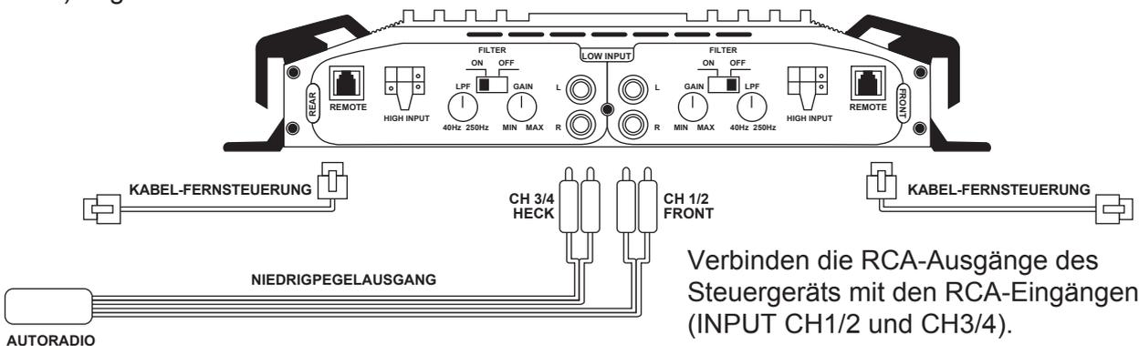
Verbinden die RCA-Ausgänge des Steuergeräts mit den RCA-Eingängen (INPUT CH1/2 und CH3/4).
