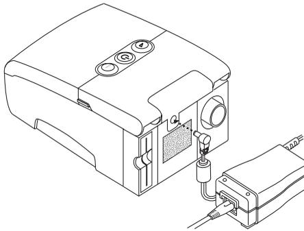
**FIGURE 3-7** CONNECTING THE POWER SUPPLY CORD TO THE DEVICE
