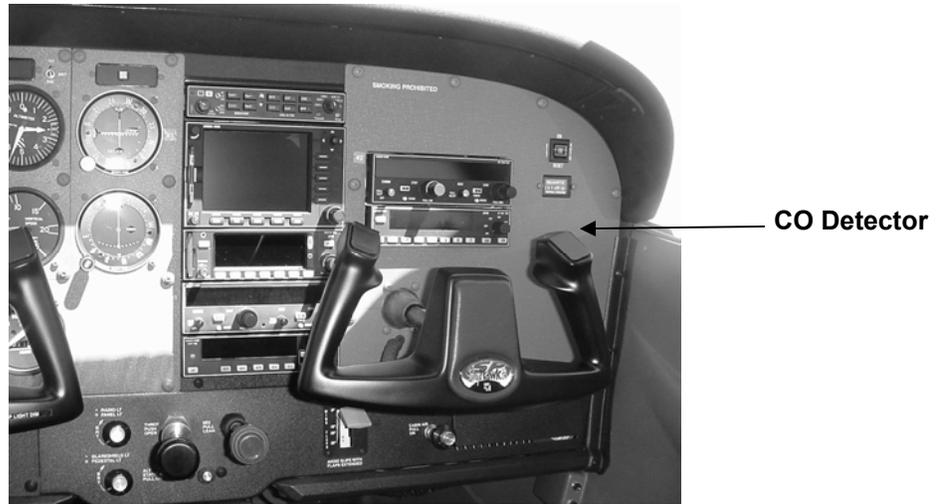
**FIGURE 1 - TYPICAL RIGHT HAND INSTRUMENT PANEL SHOWN**
