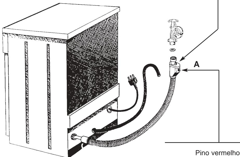
Dispositivo de segurança anti-torção (carregue e torça para remover a mangueira).
