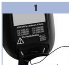
Sortez le tiroir des piles du glycomètre en appuyant le pouce et en le faisant coulisser vers le bas.
