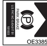
Mettre les leviers de direction au point mort et les pousser dans les fentes pour serrer le frein de stationnement de chaque côté.
