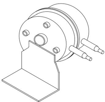
**Fig. 35: Fan-Proving Switch**
