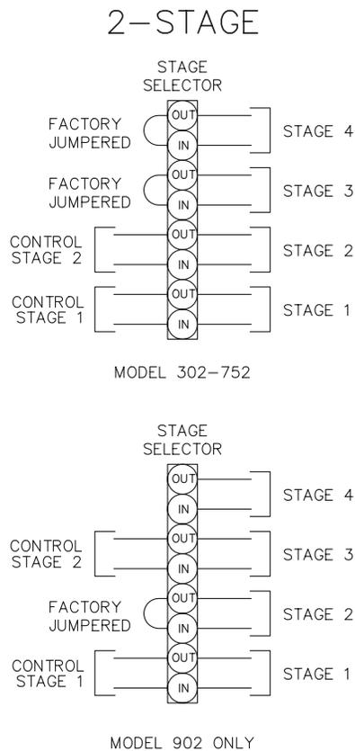
**Fig. 21: 2-Stage Wiring Connections**
