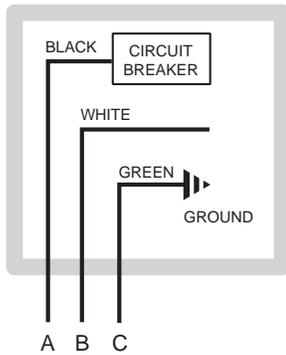
**Fig. 17: Wiring Connections**
