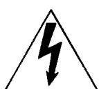
L'éclair avec une tête de flèche dans un triangle indique à l'utilisateur que les pièces à l'intérieur de l'appareil présentent un risque de chocs électriques.
