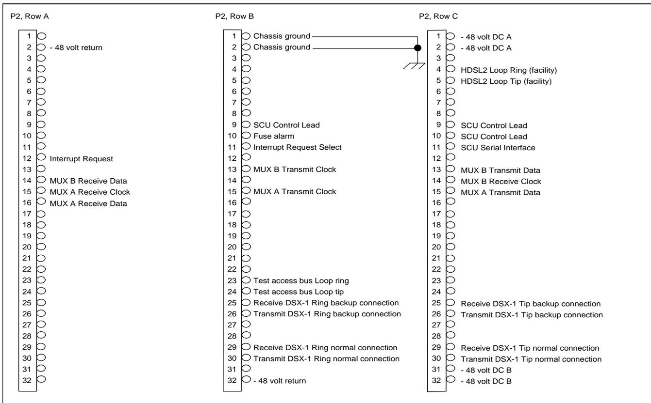
**Figure 3. H2TU-C Edge Connector Wiring**
