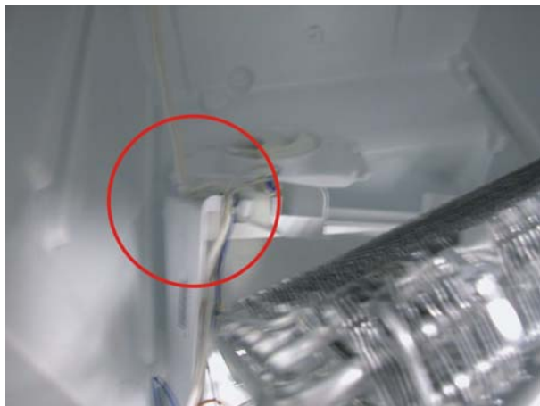
t) Remove the wiring fixing tie.
