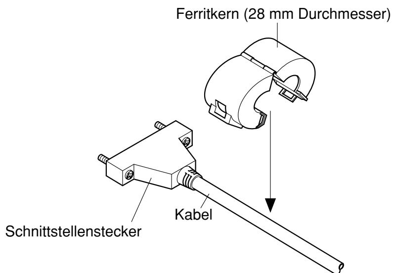
Führen Sie den Kabelbinder durch den Ferritkern.
