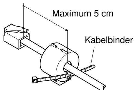
Das Befestigungsband um das Kabel wickeln und sperren.
