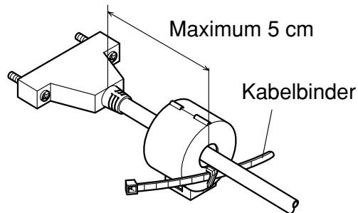
Führen Sie den Kabelbinder um das Kabel und sperren Sie ihn.
