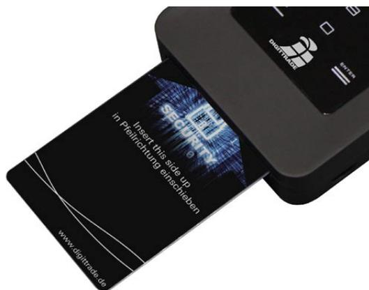
Ist eine gültige Smartcard eingelegt, leuchtet die „STATUS“-LED ein Mal. Anschließend ist das Touchpad der Festplatte beleuchtet und zur PIN-Eingabe bereit.
