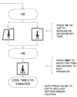
\* NOTE- THE MAX TEMP WILL BE REGULATED BASED ON THE RADIAL OR AXIAL CONFIGURATION OF DRY. THE MAX DRYING TEMP FOR A RADIAL DRYER IS 190 °F AND THE MAX DRYING TEMP FOR AN AXIAL DRYER IS 150 °F
