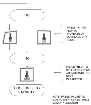
\* NOTE- THE MAX TEMP WILL BE REGULATED BASED ON THE RADIAL OR AXIAL CONFIGURATION OF DRY. THE MAX DRYING TEMP FOR A RADIAL DRYER IS 190 °F AND THE MAX DRYING TEMP FOR AN AXIAL DRYER IS 150 °F
