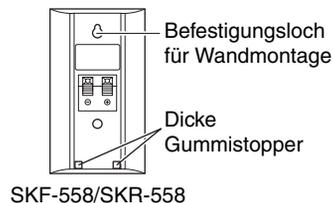
Um den Center-Lautsprecher horizontal zu montieren, verwenden Sie die beiden Befestigungslöcher, um den Lautsprecher an zwei Schrauben aufzuhängen, die sicher in die Wand geschraubt wurden.
