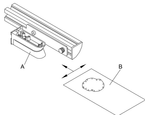
Die Etikettenlichtschanke kann durch Papierstaub verschmutzen. Dadurch kann die Etikettenabtastung beeinträchtigt werden.
