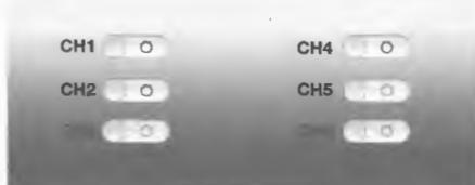
各チャンネルを操作して、サーボの回転方向、モーターの回転方向が反対の場合に使用します。該当するチャンネルをタップして回転方向を反転させてください。
