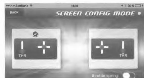
スロットルを左側のカーソルで操作するのか、右側のカーソルで操作するのかを選択することができます。また、「6CH」モードの場合には[throttle spring]をONにすることで、カーソルから指を離した際に、カーソルが自動的にニュートラル(中立)戻るように設定を変更することができます。(通常飛行機やヘリコプターを操縦する場合にはチェックを外します。)
