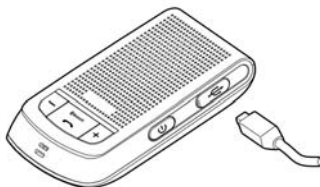
Illustration : 2 Recharge de la batterie
