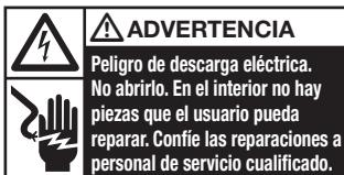
Este mensaje de seguridad significa que usted podría sufrir lesiones graves o la muerte si abre el producto y queda expuesto al voltaje peligroso.
