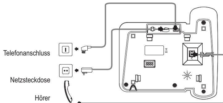
**⚠ Achtung:** Verwenden Sie für das Tischgerät nur das mitgelieferte Steckernetzgerät !
