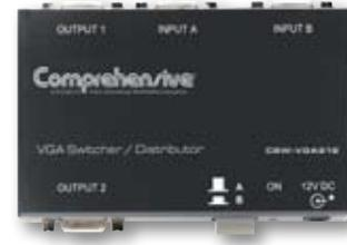
**2x1 VGA/XGA Switcher 1x2 VGA/XGA DA**
