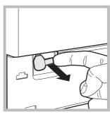
4. потяните наружу язычок, показанный на схеме, вплоть до освобождения пластикового блокировочного винта. Затем потяните его вниз, пока не услышите щелчок, что означает разблокировку люка.
