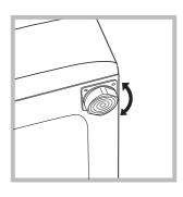
2. Skompensować nierówności odkręcając lub przykręcając nóżki aż urządzenie znajdzie się w położeniu poziomym (jego nachylenie nie powinno przekraczać 2 stopnii).
