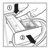
Чтобы вынуть дозатор, нажмите на язычок (1) и вытащите дозатор (2) (см. рисунок). Промойте ячейку под струей воды. Эта операция должна выполняться регулярно.
