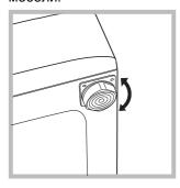
2. Выровняйте машину при помощи регулируемых ножек до полного выравнивания (наклон не должен превышать 2-х градусов).
