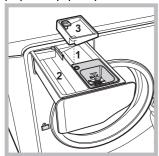
Μπορεί να χρησιμοποιείται με ή χωρίς λευκαντικό. Αν επιθυμείτε να διενεργήσετε και τη λεύκανση εισάγετε την πρόσθετη λεκανίτσα 3, που παρέχεται, στη λεκανίτσα 1. Αν επιθυμείτε μόνο λεύκανση χωρίς πλήρες πλύσιμο, χύστε το λευκαντικό στην πρόσθετη λεκανίτσα 3, θέστε το πρόγραμμα "Ξέβγαλμα" 🖑
