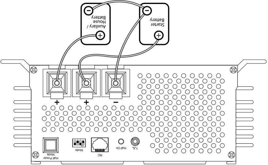
*Schéma 7.1 Brancher 2 systèmes de batteries distinctes à 2 banques distinctes*
