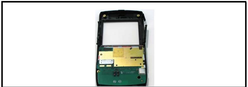
**Figure 27. Display Module Removed**
