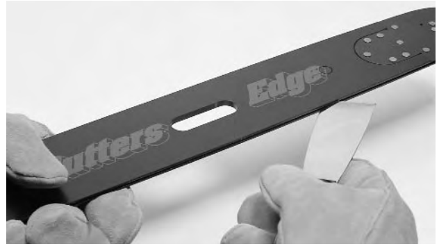
Fig. 27. Cleaning bar groove
