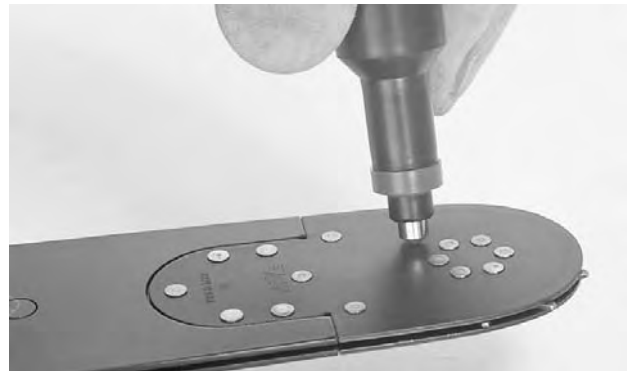
Fig. 29. Lubricating sprocket bearings
