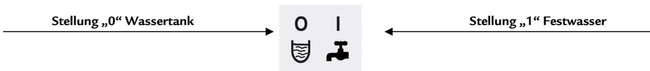
**Gerät im Betrieb mit Festwasseranschluss**
