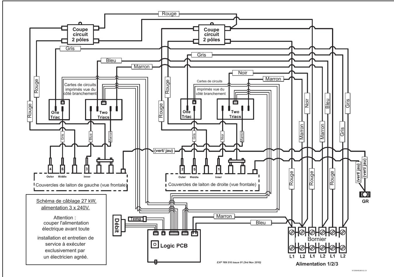
Fig. 3 Schéma de câblage interne pour l'unité monophasée WH27.
