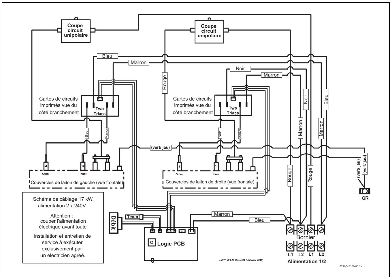
Fig. 4 Schéma de câblage interne pour l'unité monophasée WH17.
