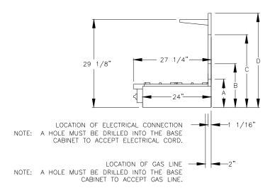
A - ISLAND TRIM HEIGHT - 9 3/8" B - 6" STANDARD BACKGUARD HEIGHT - 14-3/8" C - 17" BACKGUARD HEIGHT - 25-3/8" D - HIGH SHELF BACKGUARD HEIGHT - 32 1/8"
