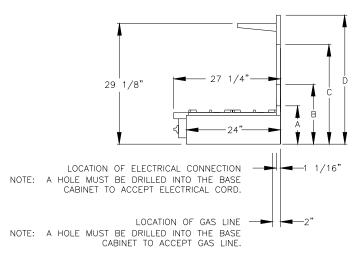
A - ISLAND TRIM HEIGHT - 9 3/8" B - 6" STANDARD BACKGUARD HEIGHT - 14-3/8" C - 17" BACKGUARD HEIGHT - 25-3/8" D - HIGH SHELF BACKGUARD HEIGHT - 32 1/8"
