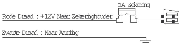
Dit is de hoofdverbinding van het alarmsysteem met de massa. Zorg ervoor dat deze verbinding tot stand komt met een stevig onderdeel van het chassis. Verbind deze draad niet met een bestaande aardingsdraad van de fabriekskabelboom. Verbind hem rechtstreeks aan het koetswerk van het voertuig.
