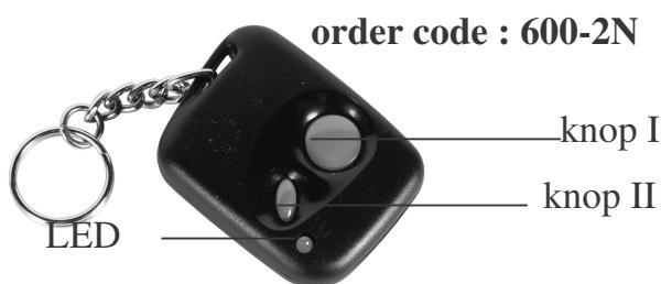
Waarschuwing ! Ingeval van een onderbreking van de voedingsspanning zal de alarmmodule de reeds geprogrammeerde zendcodes niet onthouden. Programmeer de zendcodes in dit geval opnieuw. Volg hierbij de bovenvermelde stappen. De module is standaard op gemengde sirenentoon ingesteld en de sensor op gevoelighedsniveau 3.
