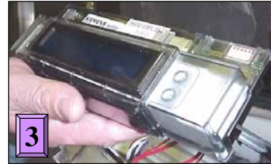
Removing display module
