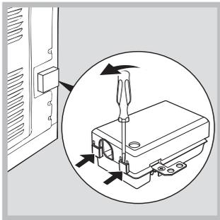
1. Abra el panel de bornes haciendo palanca con un destornillador sobre las lengüetas laterales de la tapa: tire y ábralo (ver la figura).
