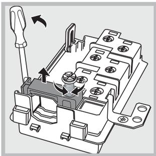
3. Tire os parafusos dos contactos L-N e, em seguida, prenda os fios embaixo das cabeças dos parafusos a obedecer as cores: Azul (N) Castanho (L) Amarelo-Verde ( $\perp$ ).
