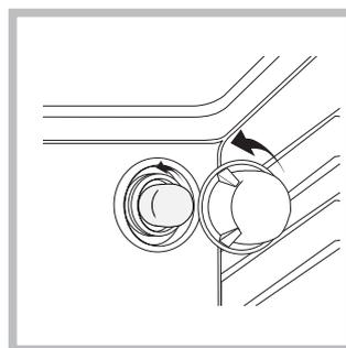
2. Dévissez l'ampoule et remplacez-la par une autre de même type : puissance 25 W, culot E 14.
