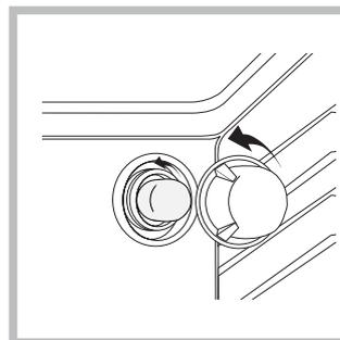
2. Svitare la lampadina e sostituirla con una analoga: potenza 25 W, attacco E 14.
