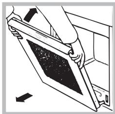
3. segure a porta dos dois lados exteriores e feche-a novamente devagar mas não inteiramente; Em seguida puxe a porta para a frente e retire-a das dobradiças (veja a figura).
