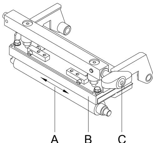
Eine Verschmutzung der Druckwalze führt zu einer schlechteren Druckqualität und kann außerdem zu Beeinträchtigungen des Materialtransports führen.
