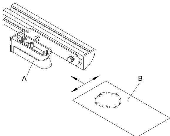
Fotocellsbrytaren kan bli smutsig genom pappersdamm. Därigenom kan identifieringen av etiketternas början påverkas negativt.
