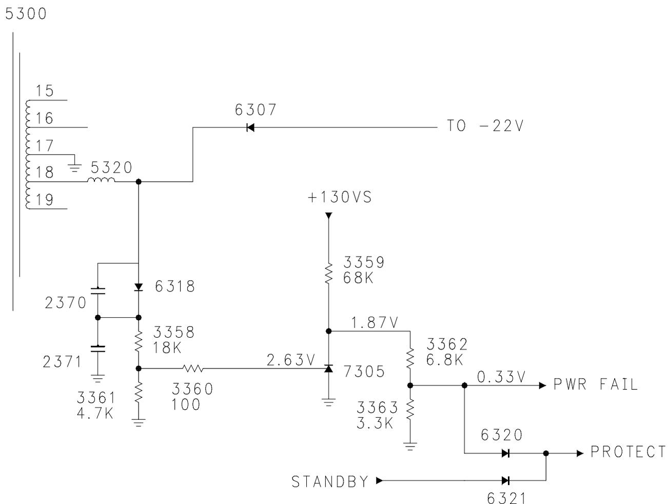
FIGURE 8 - POWER FAIL DETECTION CIRCUIT
