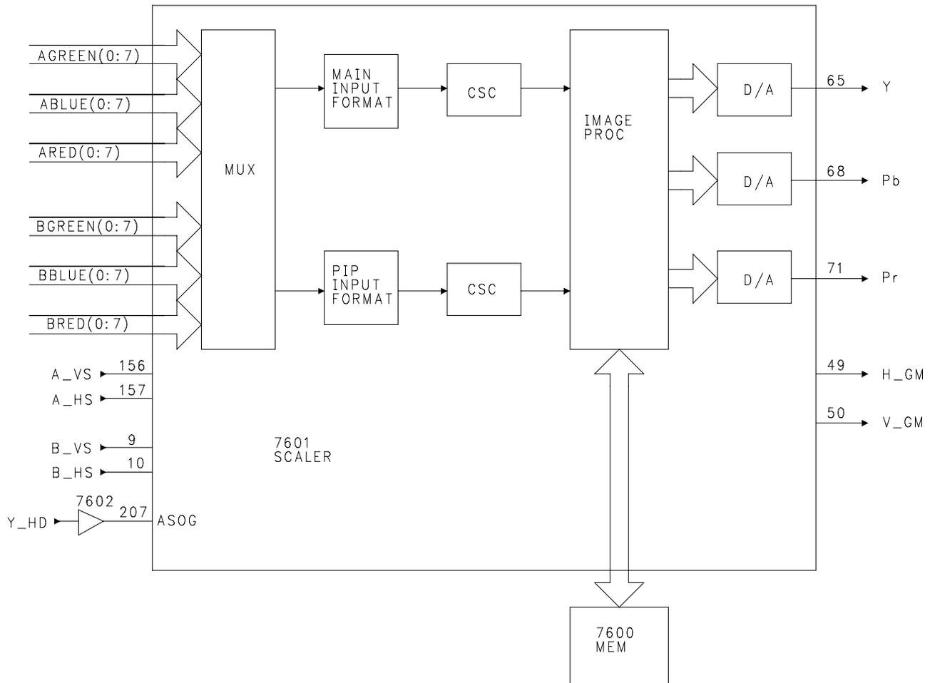
FIGURE 24 - SCALER BLOCK DIAGRAM
