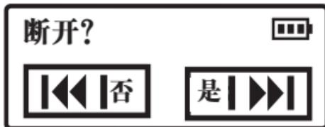
向右（▶▶|）拨动导航键断开当前的蓝牙连接，S705将进入「蓝牙可被查找模式」：
