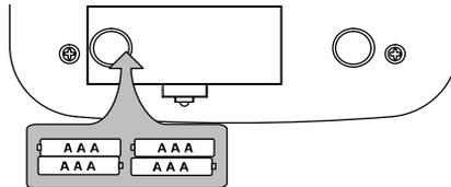
Tauschen Sie die Batterien, wenn im Display das Symbol
