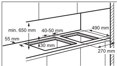
Jestliže instalujete několik varných desek o velikosti 30 cm vedle sebe do stejného výřezu, můžete si v autorizovaném servisním středisku zakoupit instalacní soupravu včetně bočního držáku a dalších těsnění. Pokyny potřebné k instalaci jsou uvedeny v balení soupravy.
