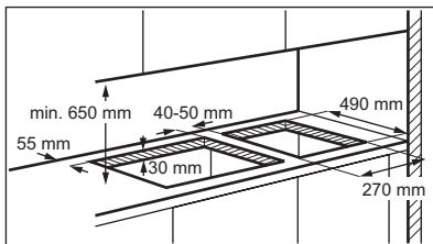
Dacă urmează să se instaleze mai multe plite de 30 cm una lângă alta, în aceeași deschidere, la centru de service este disponibil un kit de montare care include un suport lateral și garnitură suplimentare. Instrucțiunile corespunzătoare de instalare sunt furnizate în pachetul kit-ului.
