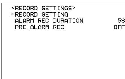
3. Зрительно проверьте, что положение курсора соответствует опции "RECORD SETTING" и, затем, поверните кольцо SHUTTLE по часовой стрелке.
