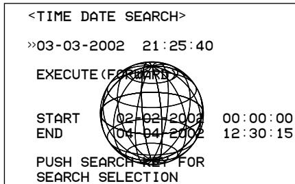
☞ S'il n'y a pas d'enregistrement pour la date réglée, la séquence vidéo de l'heure et de la date les plus proches pour la caméra sélectionnée s'affiche sous forme d'une image fixe.
