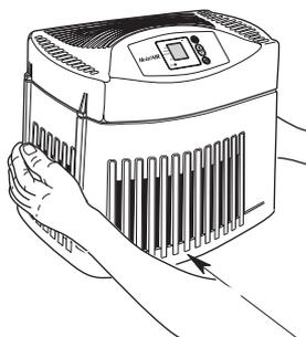
Alignez le fond de l'ensemble de bâti avec le dessus de la base et repositionnez en vous assurant que l'appareil est solidement réinstallé.
