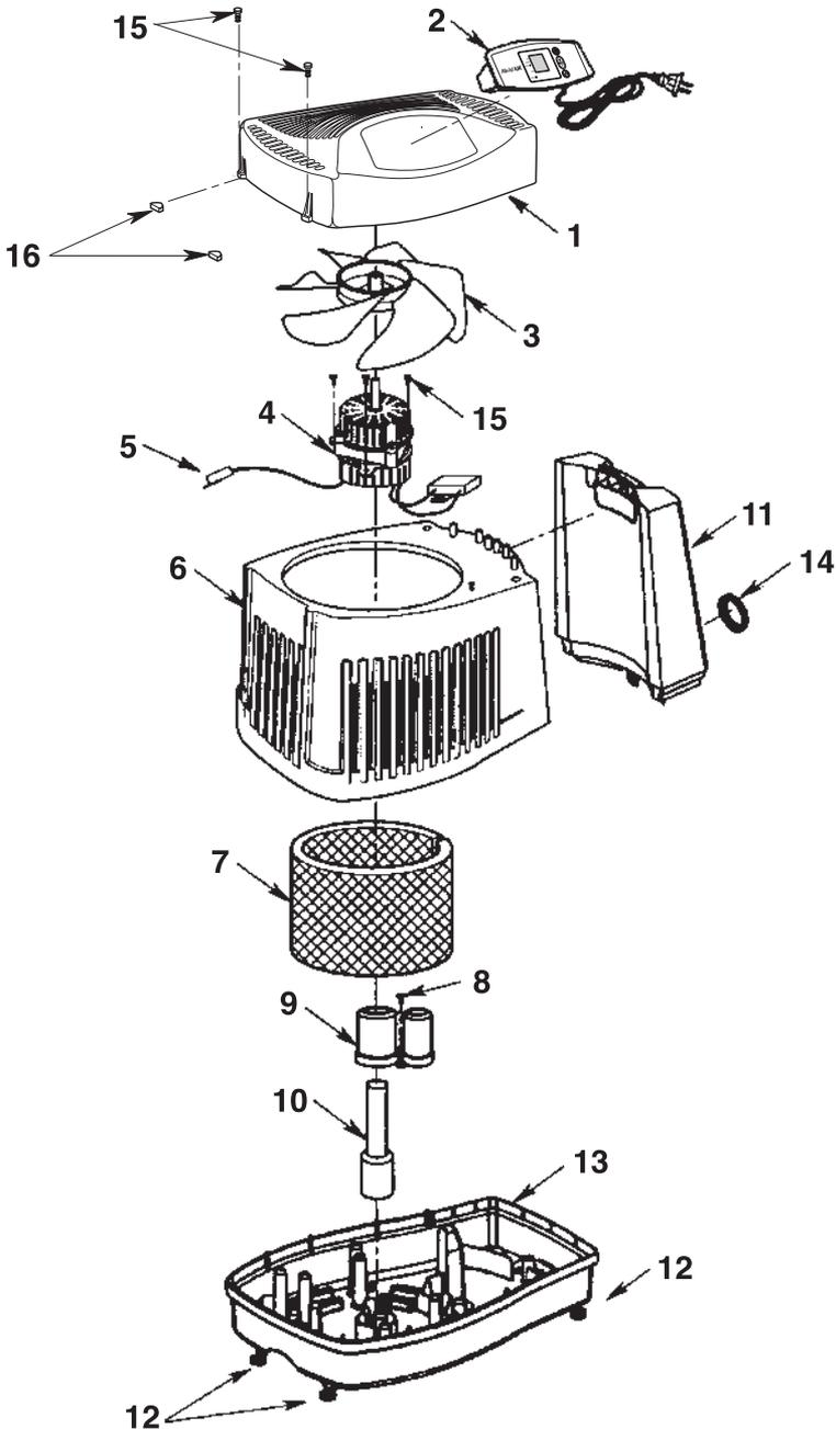
Liste des pièces de rechange pour l'humidificateur évaporatif à console MoistAIR® -
