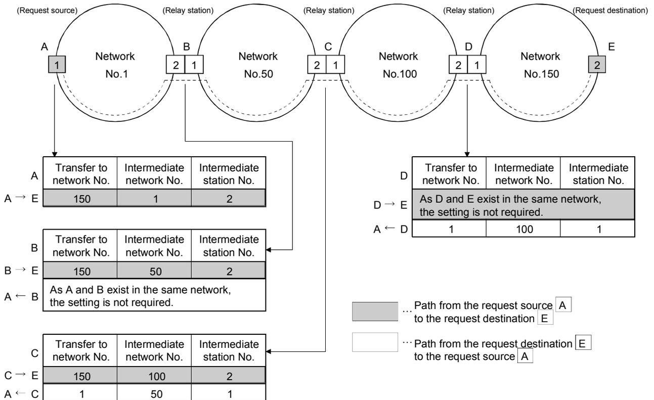
(2) Routing parameter of PLC A
