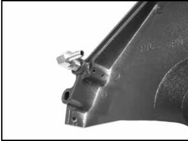
(D) Remove the Blade Guard Intake Fitting
