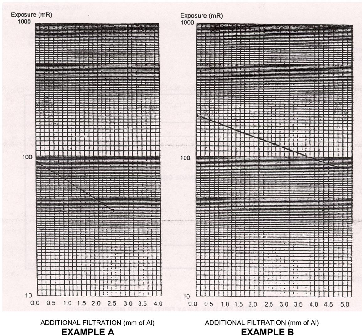
**FIGURE 5-6 HALF-VALUE LAYER DETERMINATION GRAPHS**
