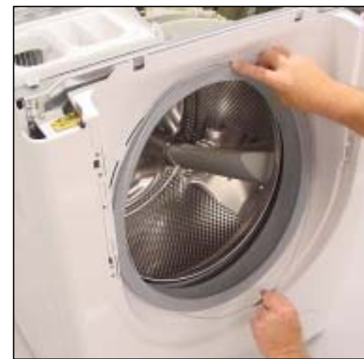
Remove door seal spring
