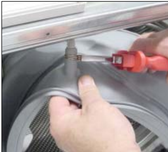
Remove door seal
