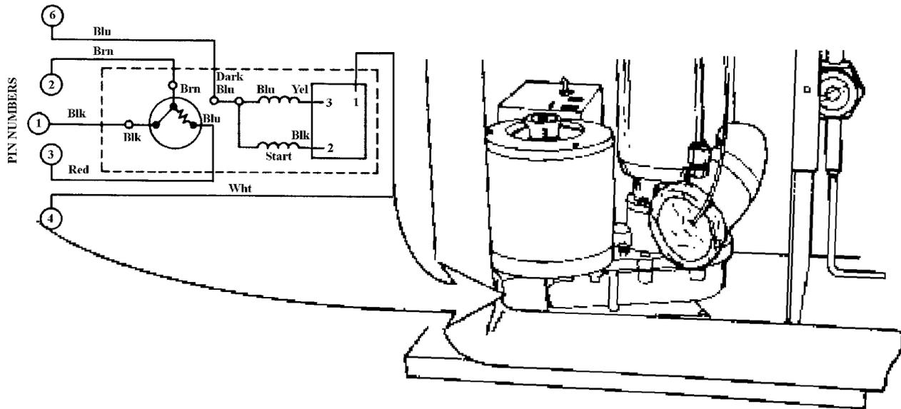
FIGURE 7. GEARMOTOR ASSEMBLY
