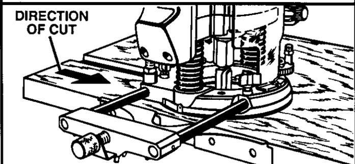
ROUTING ALONG A STRAIGHTEDGE WITH OPTIONAL EDGE GUIDE ATTACHMENT Fig. 24
