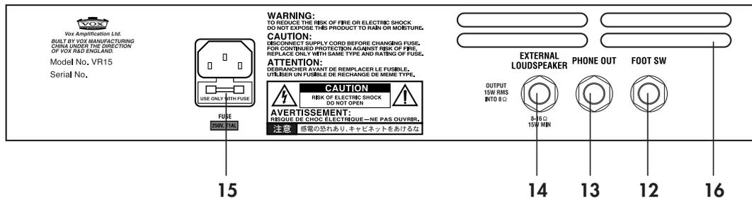
**12. FOOT SWITCH:** Puede usar un interruptor de pedal opcional VF-001.
