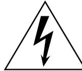
Der als Pfeil dargestellte Blitz in einem Dreieck weist den Anwender auf nicht isolierte, „gefährliche Spannungen“ im Geräteinneren hin, die so stark sein können, dass sie einen Stromschlag verursachen.
