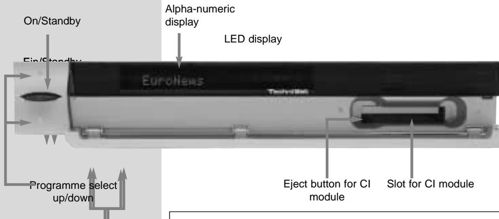
Inserting the CI module:
